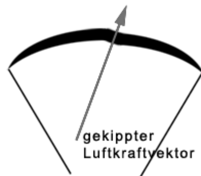
Abb. 12 Steuerung durch Gewichtsverlagerung nach [3]
