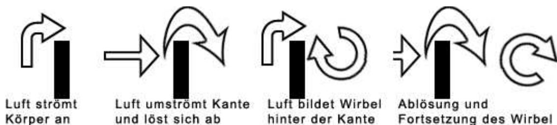
Abb. 4 Wirbelbildung an umströmtem Körper nach [3]
