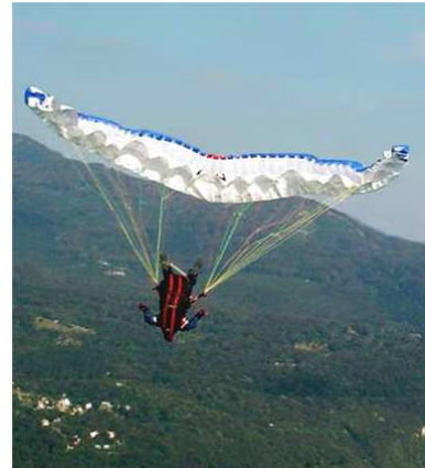
Abb. 15 Fullstall, Fall des Piloten in die Kappe [14]
